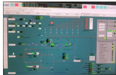
ระบบ Steam Injection ร่วมกับ SCR
